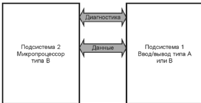
Рисунок 6 - Декомпозиция аппаратных средств
